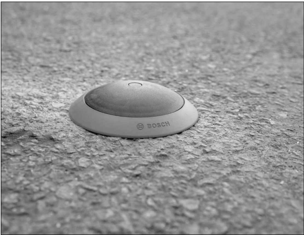
În zona istorică a orașului au fost instalați 1.200 de senzori, care îi vor ghida pe șoferi către locurile de parcare libere
